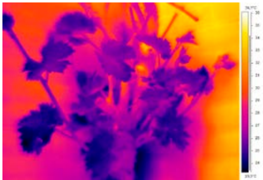
Wärmebild-Kühleffekt Kletterpflanzen gegen Wand.
